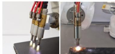
**Antorchas ULS 3 en acción sobre placa de fibra de composite y tratamiento robotizado sobre tubo de composite**
